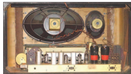
Bild 14: Innenansicht des Grundig 5010 mit den zweimal EL12-Endröhren
