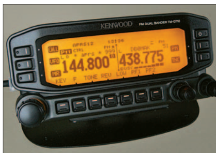
Bild 2: Das Bedienteil auf der Halterung für den Stationstisch; die beiden Bänder sind klar getrennt, die Funktion der Tasten wird im Display angezeigt.
