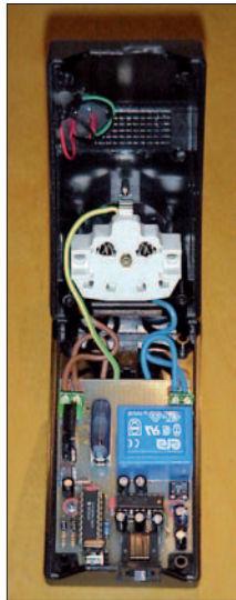
Bild 1: Innenleben des Wachhunds im aufgeklappten Steckergehäuse; durch den kompakten Aufbau lässt sich die fertige Baugruppe problemlos in die Spannungsversorgung des Servers einschleifen.
