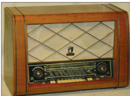
Bild 17: Neckermann Royal 111/21 mit UKW-Synchrondemodulator, gebaut von Körting
