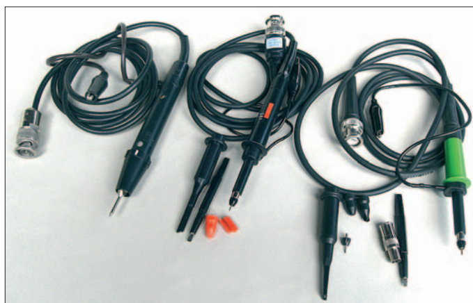
Bild 11: Wer am Tastkopf spart, spart am falschen Ende. Bereits die Mechanik entscheidet über Arbeitserleichterung oder Kontaktprobleme. Die minderwertige Krokodillklammer des OP1M-Tastkopfs (links) sorgt z. B. eher für Verdross als für eine ordentliche Masseverbindung.
