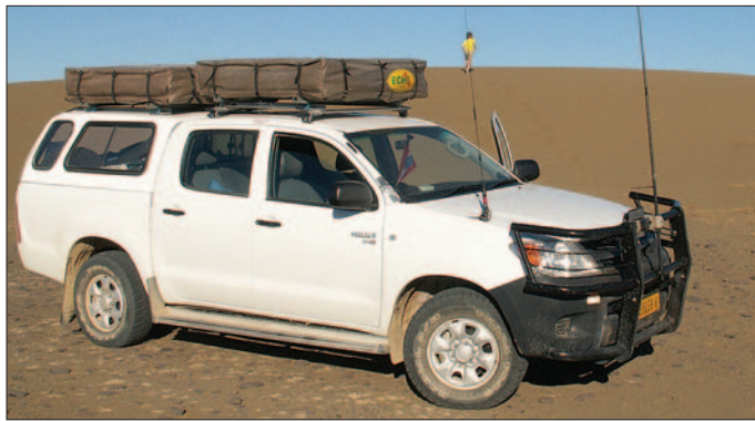
Bild 1: Am Kuhfänger des Allradfahrzeugs befand sich die Mobilantenne, sodass die Karosse als Gegengewicht für die Mobilantenne fungieren konnte.
