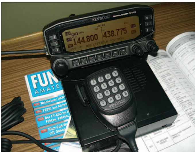
Bild 1: Bedienteil und eigentliches Funk- gerät sind getrennte Einheiten, die nur über ein Kabel verbunden sind. Der TNC steckt hier im Bedienteil.
