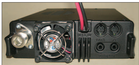
Bild 4: Der kleine Lüfter sorgt für exzellente Kühlung. Im Gegensatz zum Vorgängermodell sind alle Datenbuchsen in Mini-DIN-Norm ausgeführt.
