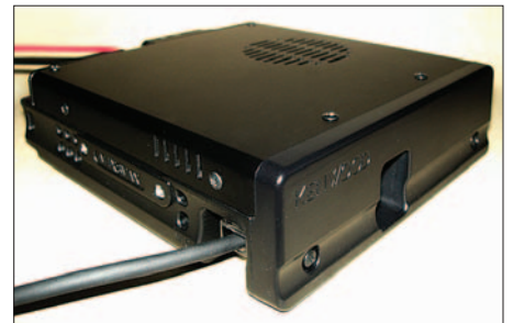
Bild 3: Das eigentliche Funkgerät; nicht verwechseln: Das Bedienteil wird vorne, das Mikrofon seitlich angeschlossen.
