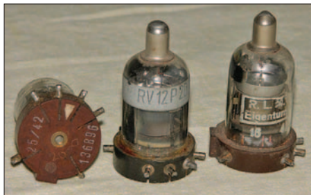
Bild 1: Die Wehrmachtströhre RV12P2000
