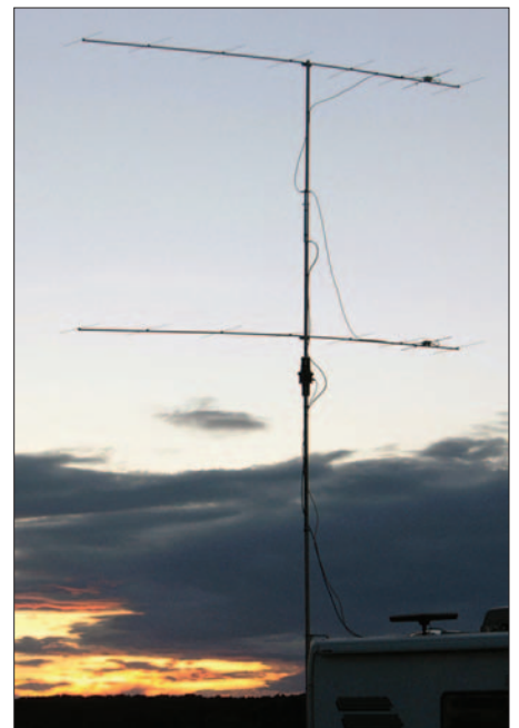
Bild 3: Gestockte Gruppe 8 über 8 für 2 m, 14,8 dBd Gewinn
