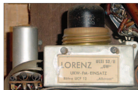
Bild 10: Einfacher Pendelaudion-Empfänger mit UCF12 (hier von Lorenz).
