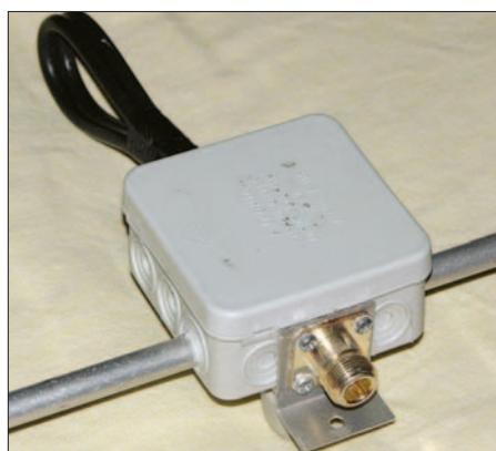
Bild 5: Ein 28-Ω-Strahler mit Winkel zum Erden der Koaxialbuchse auf einem Aluminiumtragrohr
