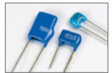
Bild 4: Sehr gute Entstöreeigenschaften haben keramische Vielschichtkondensatoren.
