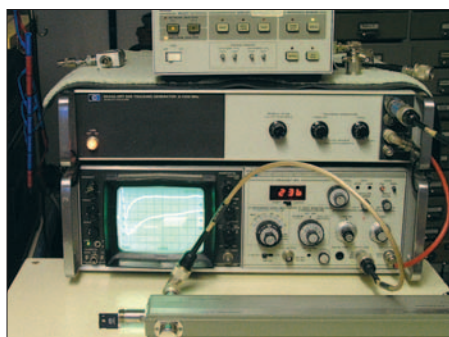
Bild 11: Messaufbau mit kommerziellem Spektrumanalysator und Richtkoppler
