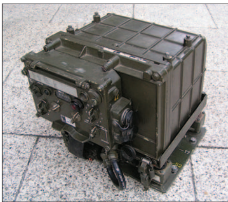
Das SEM-25 ist modular aufgebaut und besteht aus Stromversorgung, Transceiverblock und separatem Bedienteil.
