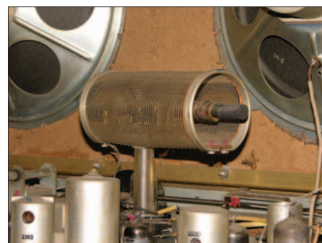
Bild 15: Drehbare, gegen elektrische Störungen abgeschirmte Ferritantenne
